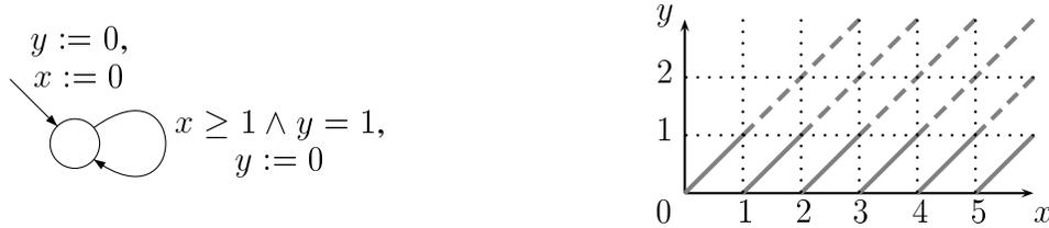
FIG. 3 – Un automate temporisé dont le calcul en avant ne termine pas.
