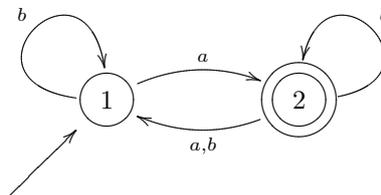
En utilisant la procédure de détermination de Safra, construisez un automate de Rabin déterministe équivalent à cet automate. Documentez, étape par étape, cette procédure.
