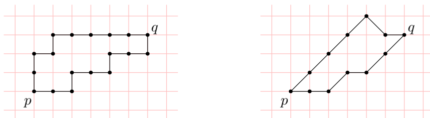
FIG. 2.6 – Des chemins minimaux entre p et q , pour d_4 (à gauche) et d_8 (à droite).
