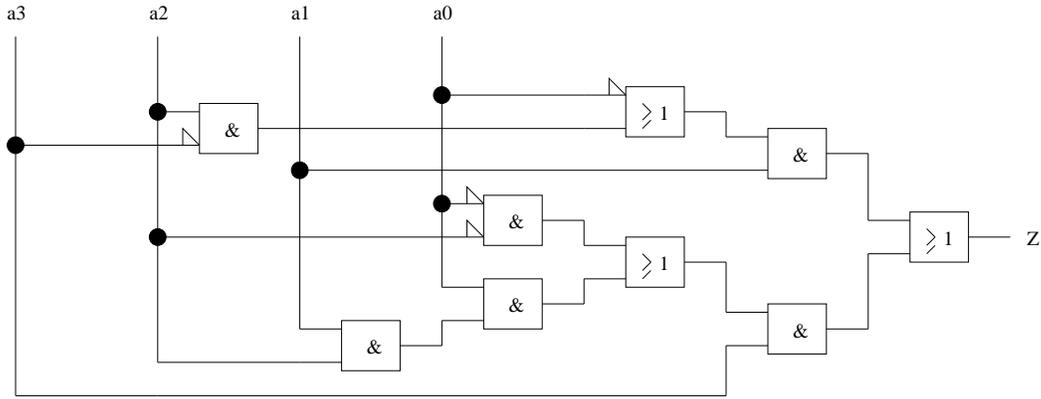
**Exercice 2.** On considère un ascenseur desservant un rez-de chaussée et trois étages. L'unité logique de contrôle de cet ascenseur reçoit en entrée des requêtes de déplacement d'un étage vers un autre, et génère en sortie les commandes correspondantes destinées au moteur de la cage. Il s'agit de réaliser les circuits qui composent l'unité de contrôle. Pour cela :
