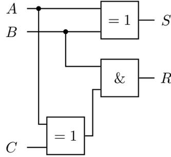
3. La table de vérité de l'additionneur/soustracteur est (avec  $R_e$ , retenue en entrée et  $R_s$  retenue en sortie) :
