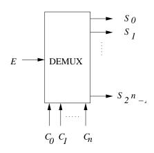
$\square$  n fils de contrôle  $C_n, C_{n-1}, \ldots, C_0$ ;
