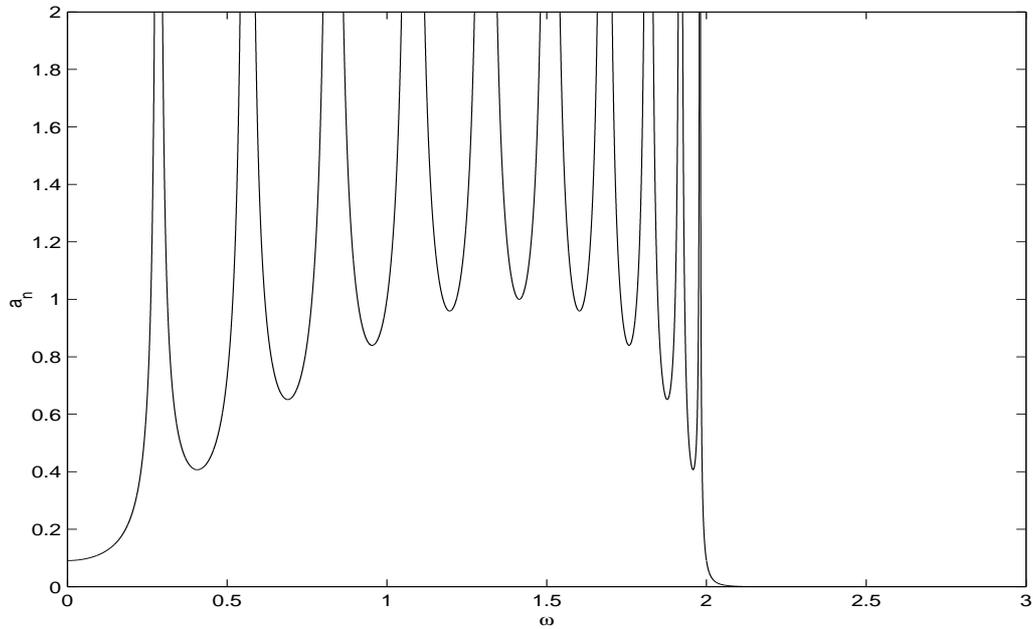
Filtre d'ordre  $n = 10$ , fréquence de coupure  $\omega_c = 2$ .
