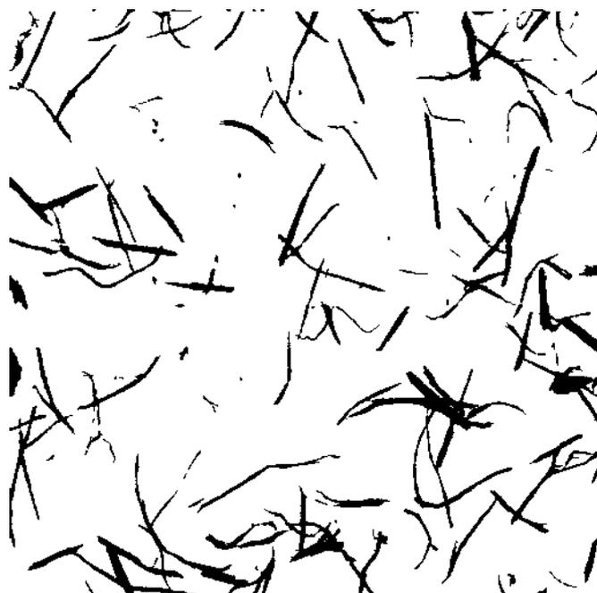
FIG. 79 - Pâte mécanique d'épicéa
