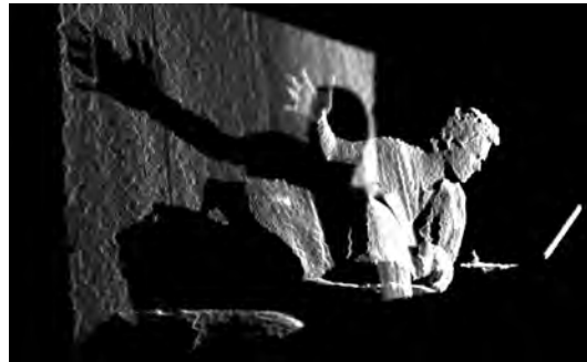
FIGURE 2.15 – Exemple de nuage de points généré en utilisant une caméra kinect 2 - Larry Li
