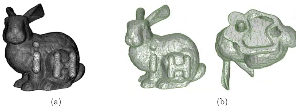
FIGURE 2.5 – Résultat de l’algorithme de simplification sur le modèle classique du “bunny” (modèle fourni par l’Université de Stanford). (a) Modèle initial (34k sommets), (b) modèle simplifié (3k sommets).
