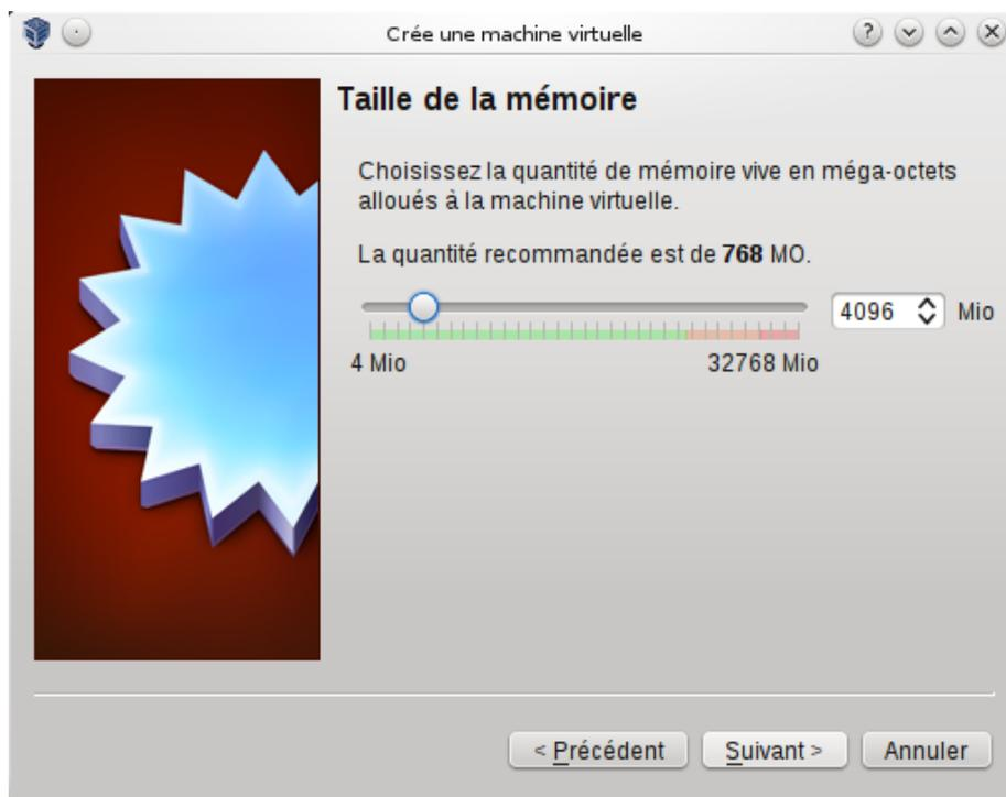
FIGURE 2 – Déclaration de la taille de la RAM de la machine virtuelle
