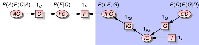
$$P(A) \times P(C|A) \times P(F|C) \times 1_C \times 1_F = P(A, C, F).$$
