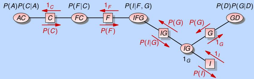
À la fin de l'algorithme, pour tout nœud  $X$ , le produit de la table stockée en  $X$  par l'ensemble des messages envoyés à  $X$  est la probabilité jointe des variables de  $X$ .
