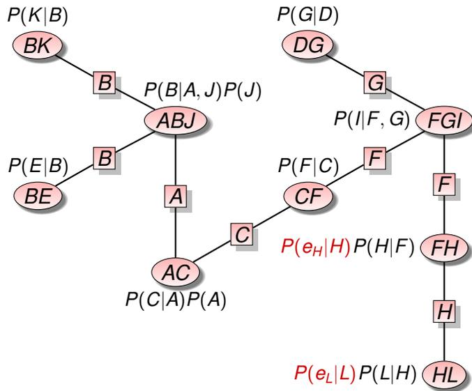
L'algorithme de Shafer-Shenoy permet donc de calculer dans la clique  $FGI$  :  $P(F, G, I, e_H, e_L)$
